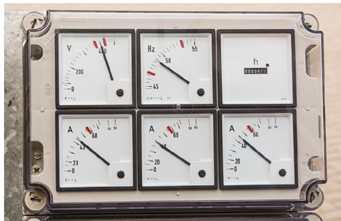
Sichere Geräte besitzen nicht nur gut ablesbare Anzeigen für die Stromaufnahme der drei Phasen, sondern auch Überwachungseinrichtungen für Über- und Unterspannung sowie für eine Über- und Unterfrequenz.
