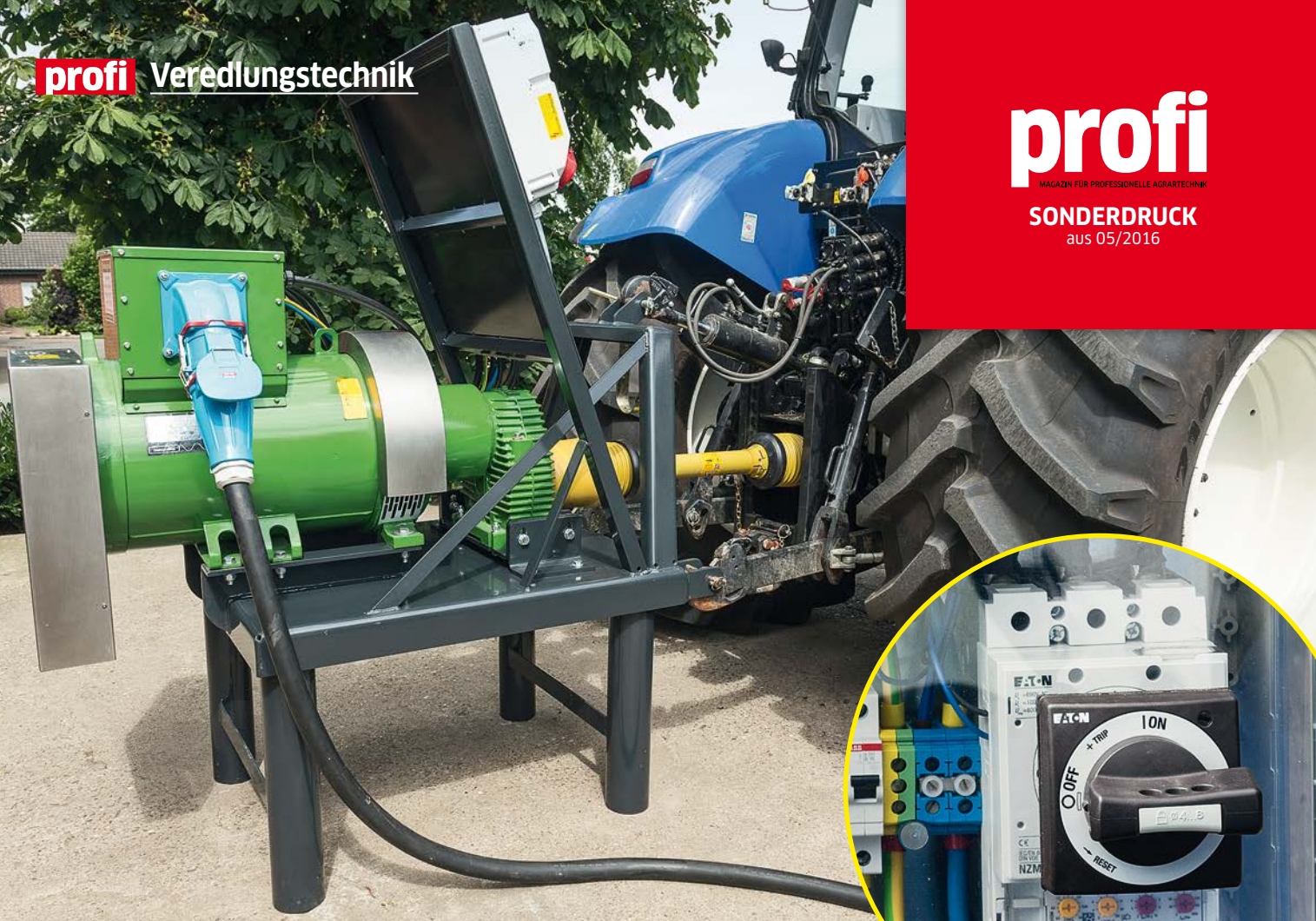
Notstromaggregate sind erst mit einem Generator-Leistungsschalter sicher. profi erklärt, warum das so ist.
