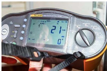
Mit einem Multifunktionstester wird die Funktion des FI vom Hausanschluss gecheckt.
