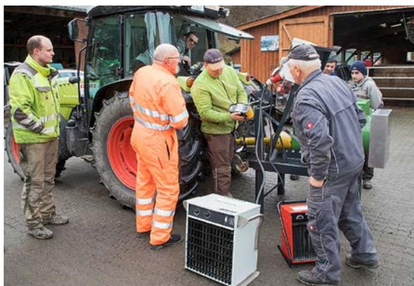
Wenn beide Heizlüfter in Betrieb sind, läuft dieser Zapfwellen-Generator unter Vollast. Ob die Schlepperleistung dann noch ausreichend ist, überprüft Kemper mit dem Landwirt vor Ort.
