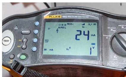
Kein Grund zur Sorge: 24 mA Auslösestrom und 1 V Auslösespannung sind gute Werte.
