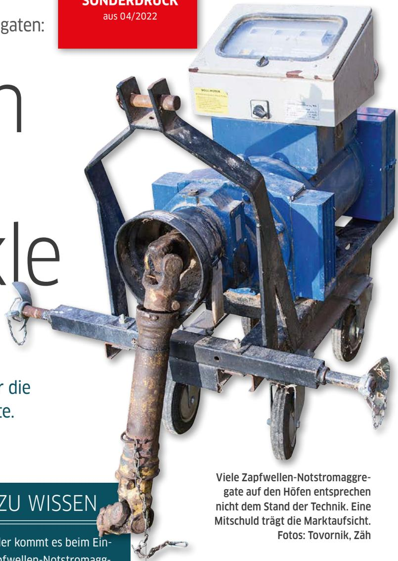
Viele Landwirte können von einem misslungenen Einsatz des Notstromaggregates mit Zapfwellenantrieb berichten. Misslungen, weil danach teure und systemrelevante Elektronik in Lüftungs- und Fütterungscomputern zu reparieren war. Auch kann geradezu regelmäßig aus dem Generator aufsteigender Qualm beobachtet werden.
