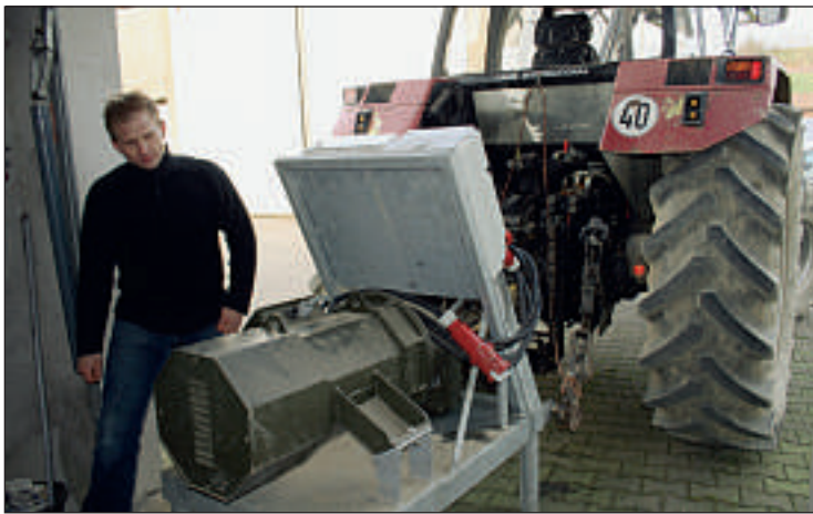
Das zapfwellengetriebene Aggregat sollte vor Wind und Wetter geschützt und in der Nähe zu einer Netzsteckdose stehen, wie zum Beispiel in der Garage. Die Leistung ist an der Schalttafel zu regulieren und zu kontrollieren.
