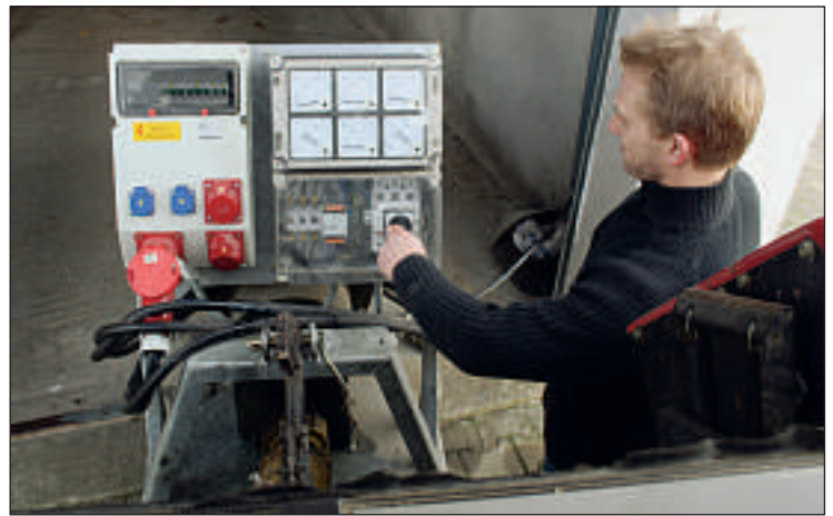
Das zapfwellengetriebene Aggregat sollte vor Wind und Wetter geschützt und in der Nähe zu einer Netzsteckdose stehen, wie zum Beispiel in der Garage. Die Leistung ist an der Schalttafel zu regulieren und zu kontrollieren.
